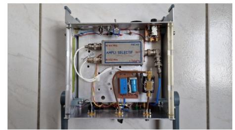
J'ai réutilisé la fixation de la sonde de mesure pour maintenir et rendre interchangeables les filtres RF.
