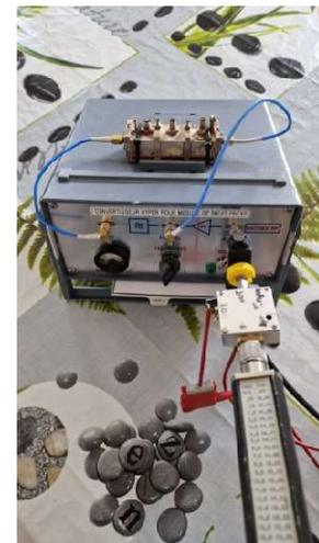
Le résultat est très encourageant, le HP8970A est utilisé en mode conversion à battement inférieur pour mesures en micro-ondes.
