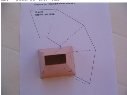
Après avoir calculé avec HDL\_ANT , on imprime la feuille, (vérifier l'échelle) on découpe un coté qui est aligné sur le bord de la plaque de cuivre de 8/10°. On scotche partout et, au fur et à mesure des découpes. Avec un cutter costaud on marque une douzaine de fois aux endroits où on veut couper et 3 à 4 fois où on veut plier.
