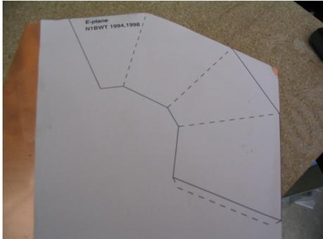
un régllet avec 2 serres joint et 12 coups de cutter pour couper, 3 à 4 pour marquer le pliage
