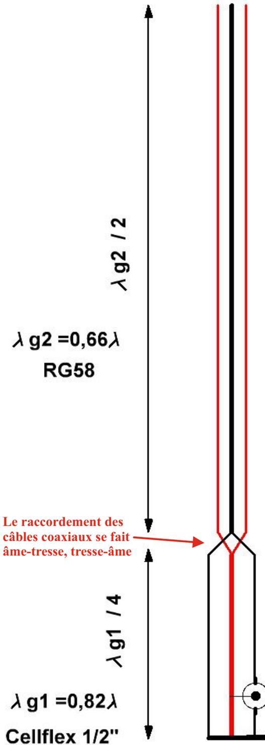
Le raccordement des câbles coaxiaux se fait âme-tresse, tresse-âme
