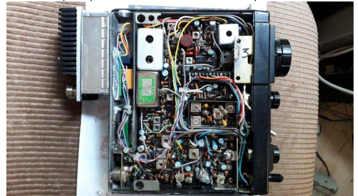
Côté carte principale et commutation 12/24V à la place de l'antenne
